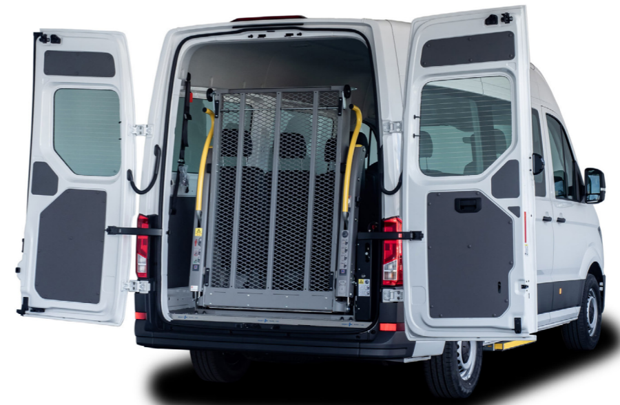
Detalle de puertas traseras con plataforma elevadora
