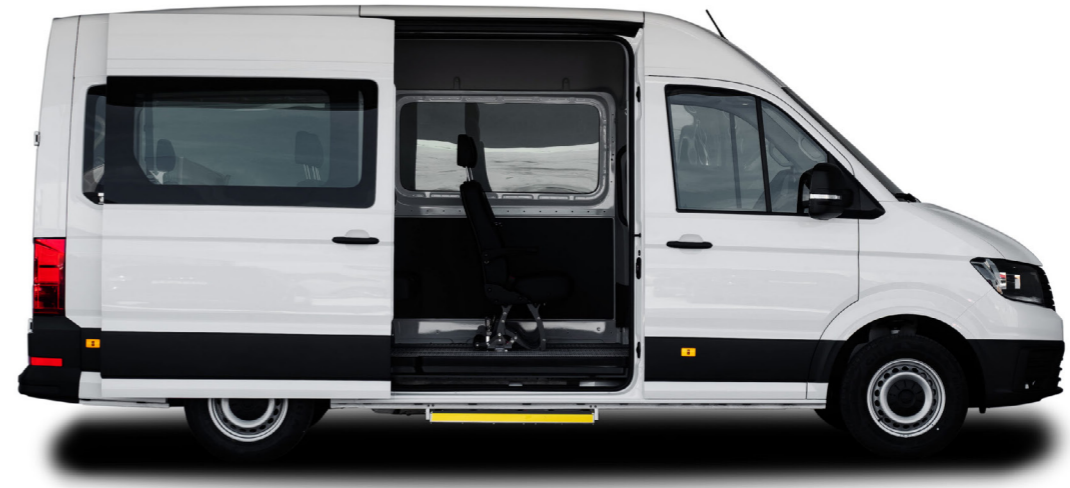
Detalle de puerta lateral con escalón retráctil
