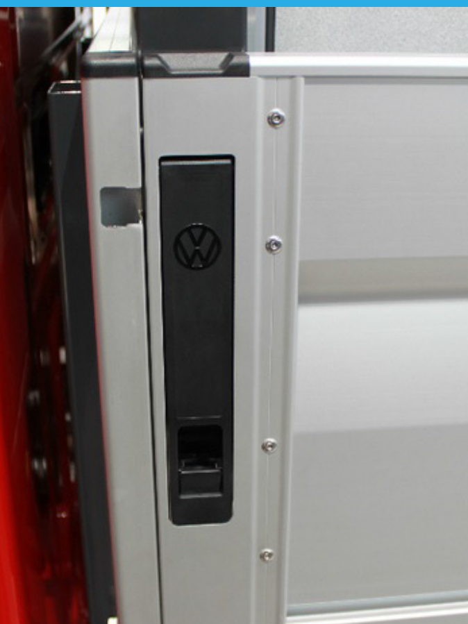
Detalle de cierre del lateral abatible
