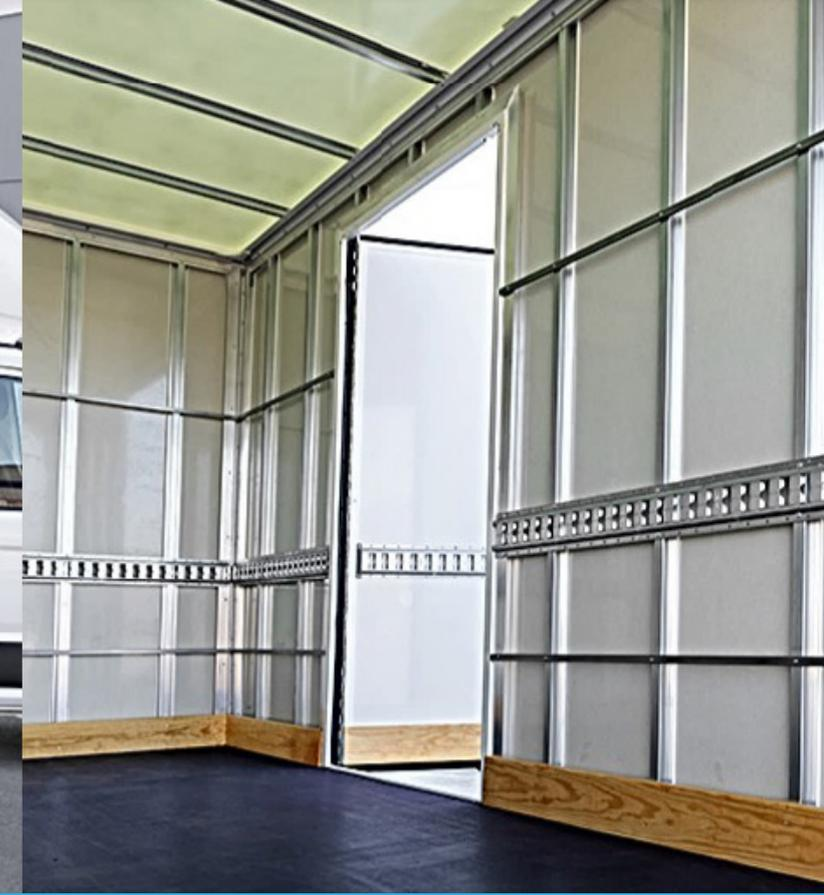
Puerta lateral situada a 1.000 mm. del frontal y fabricada en panel de sándwich (1945x900x30 mm.) con cierre independiente; especialmente recomendada si el vehículo incorpora plataforma elevadora o para servicios que requieran acceso lateral extra.
