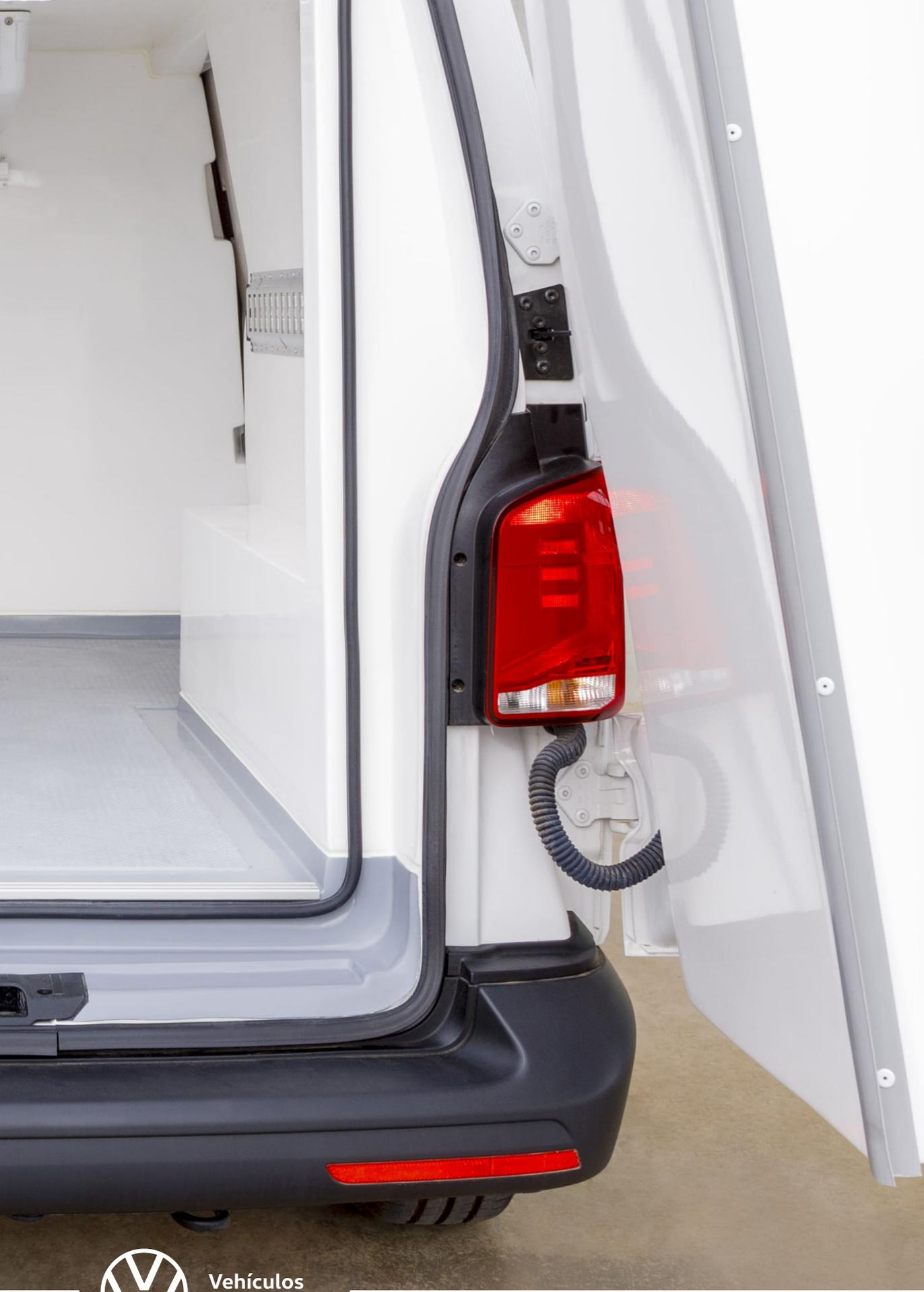
Los revestimientos de la conversión se han diseñado para reducir al máximo el intercambio de temperatura en el interior del área de carga, además de optimizar el volumen y la carga útil utilizando los procesos de fabricación más avanzados y buscando el mayor estándar de calidad del mercado. Y por supuesto cumpliendo con la normativa para el transporte de mercancías perecederas ATP.
