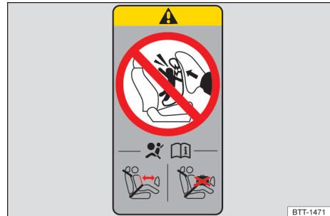
Fig. 2 Adhesivo relativo al airbag en el pilar A o en el pilar B (representación esquemática).
