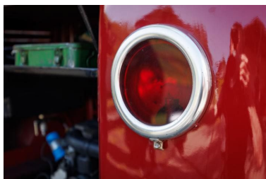
Un piloto trasero grande en lugar de dos pequeños garantiza la visibilidad trasera en la oscuridad
