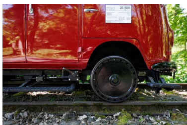
El diámetro de la rueda es de 550 mm
