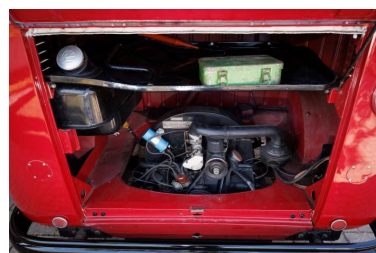
El motor industrial Volkswagen produce 21 kW / 28 CV con una cilindrada de 1.192 cc.
