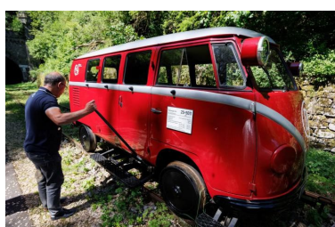
Con una bomba manual, el vehículo se puede levantar y luego girar
