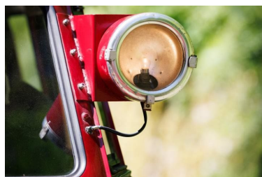
De acuerdo con la normativa ferroviaria, se han instalado dos nuevos faros.
